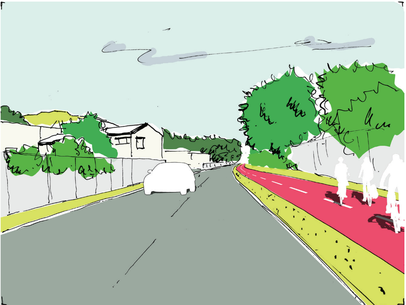
Abb. 34 Ideenvisualisierung Anlage eines abgesetzten 2-Richtungs-Radweges (Qu.: DTP)
